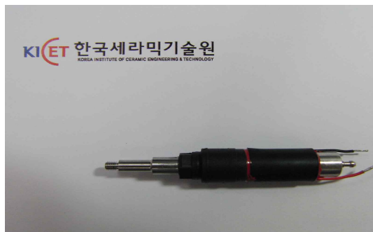
그림 6. 제작된 압전형 초음파 스케일러. Fig. 6. Piezoelectric ultrasonic scaler produced.
