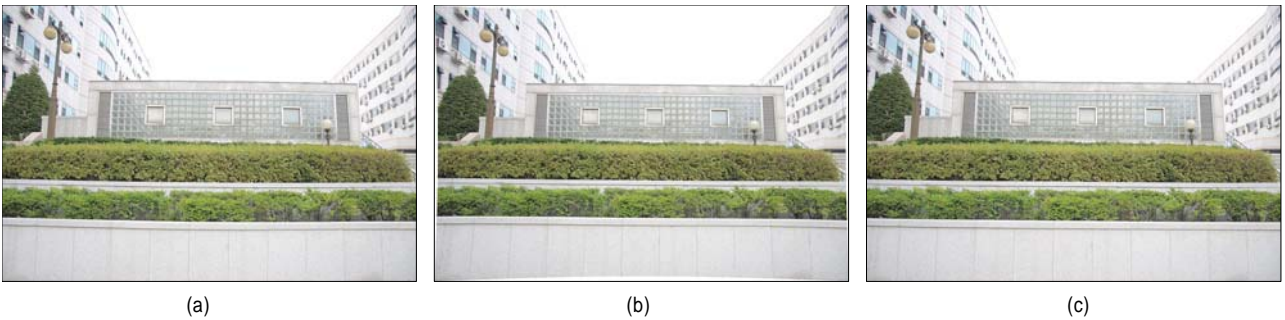
그림 14. 렌즈 왜곡 보정 영상. (a) 초점거리가 20mm인 원 영상, (b) 렌즈 왜곡 계수 5.776을 이용해서 렌즈 왜곡 보정한 영상, (c) PTLens를 이용해서 렌즈 왜곡 보정한 영상 Fig. 14. Lens distortion correction. (a) original distorted image of focal length 20mm, (b) corrected image using the distortion parameter 5.776, (c) corrected image using PTLens
