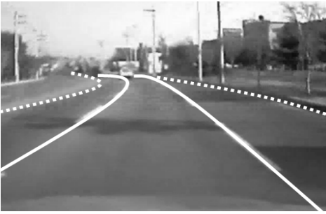
그림 13. 클로소이드 모델 기반 차선추정
