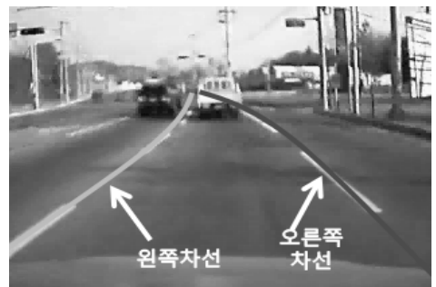
그림 12. 도로 모델 기반 차선인식 Fig. 12. Lane detection based on road model
