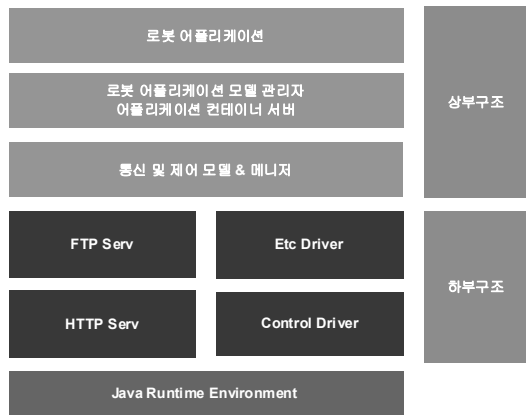
그림 3. 로봇 소프트웨어 계층 구조 Fig. 3. Hierarchical structure for robot software
