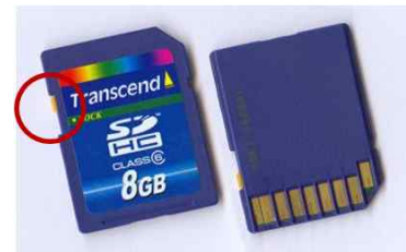
그림 3. SD 플래쉬 메모리에 쓰기방지 설정 Fig. 3. Write protect of SD flash memory
