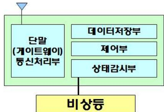
그림 2. 단말(게이트웨이) 비상등감시장치 구조도
