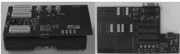
(그림 10) IEEE 802.15.4기반 센서 노드 프로토타입
