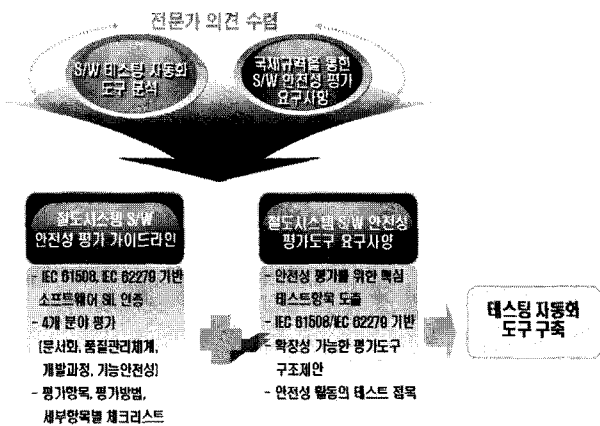
그림 1 철도시스템 소프트웨어를 위한 자동화 테스트 도구 개발의 개요
