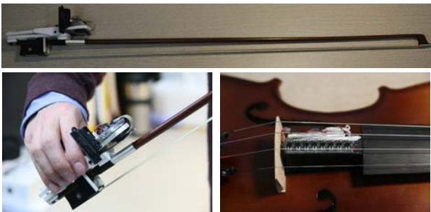
그림 5. 활의 힘, 속력, 위치를 측정하기 위한 하드웨어 장치. Fig. 5. Hardware devices for experiment on measuring bowing force, velocity and position.
