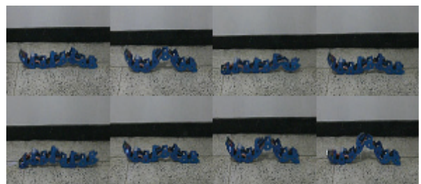
그림 14. GAttr 방식을 사용한 실제 KMC 로봇의 움직임. Fig. 14. Locomotion of Real KMC Robot using GAttr method
