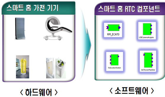
그림 8. 친환경 스마트 홈 가전기기용 RT 컴포넌트 Fig. 8 RT middleware for environment-friendly smart home appliance
