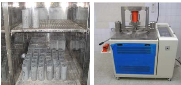
(a) 증기양생 전 모습 (b) 오토클레이브 양생 모습
