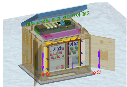
그림 3 침수방지용 장치 시스템 외형도 Fig. 3 The outward diagram of flood protection equipment system
