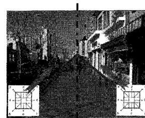
그림 4. 양쪽 영역에서 체인코드를 이용한 직선 성분의 검출. Fig. 4. Line extraction in both side using chain-code.
