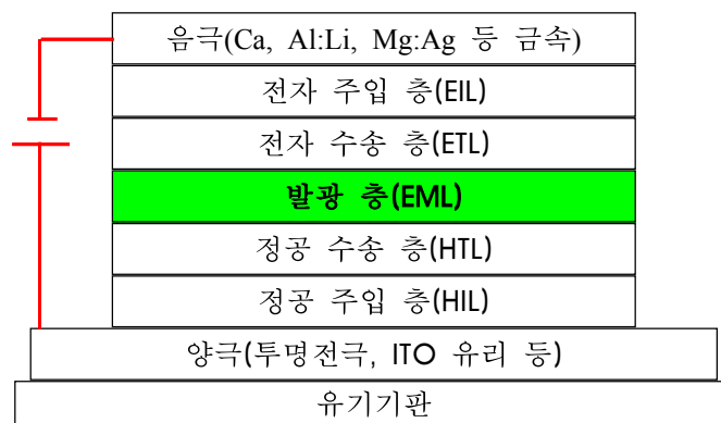
<그림 1> OLED의 기본 구조도
