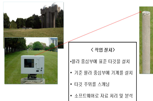
[그림 7] EDM 기선장을 이용한 지상레이저스캐너 성능 평가 7)
