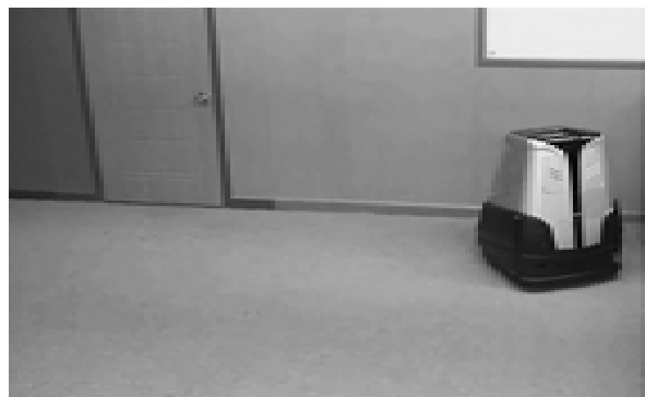
그림 14. 빌딩청소용 이동로봇의 벽면 주행
