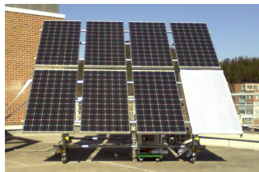
그림 5. 실험에 사용된 PV 시스템의 사진. 흰색 모듈은 차광막이 설치된 부분임.
