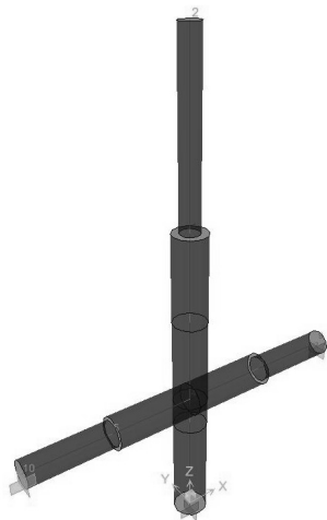
〈그림 9〉 345kV 변전소 절연애자의 해석 모델
