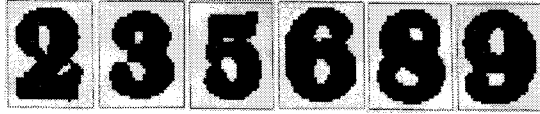
[그림 2] 혼돈 숫자 : 위의 모든 숫자는 내부 구조적으로 두 개의 홀(hole)을 가진다.
