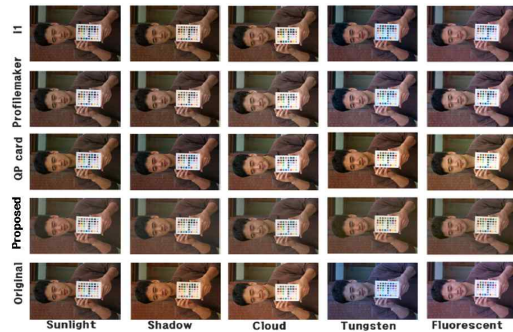
(그림 10) 화이트 밸런스 왜곡에 대한 컬러 보정 결과 영상
