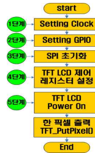
(그림 3) TFT LCD 구동 순서도
