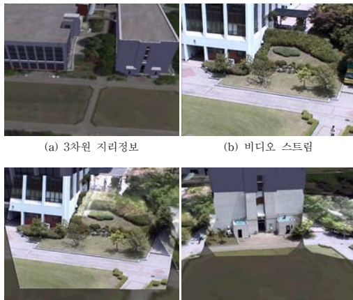
(c) 3차원 지리정보에 비디오 스트림을 투영 텍스처 매핑한 결과 (d) 3차원 지리정보에 다중 비디오 스트림을 투영 텍스처 매핑한 결과
