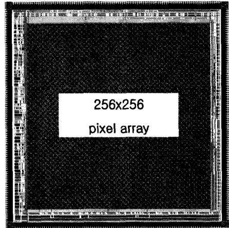
그림 9. 256 x 256 어레이 전체 칩 레이아웃 Fig 9. 256 x 256 pixel array full chip layout
