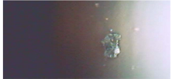
그림 30 HTR 내부 이물질 점검 결과(제거전) Fig. 30 The check diagram for slug in HTR inner part(before removal)
