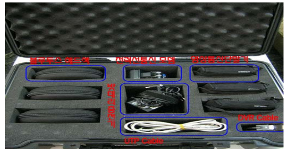
그림 18 정비 감시시스템의 단말기 내부 구성도 Fig. 18 The inner construct diagram of equipment monitoring system terminal
