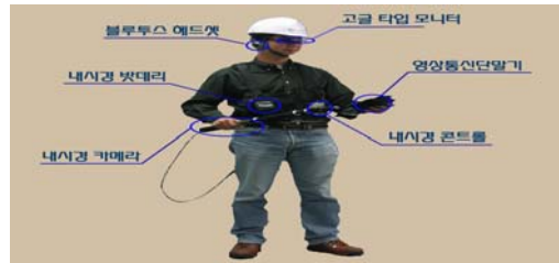
그림 8 제안 시스템의 내시경 작업 장비 착용도 Fig. 8 The diagram of endoscope working for proposed system
