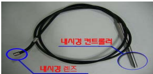
그림 6 적용된 \Phi 9[mm] 내시경 카메라 Fig. 6 The endoscope camera with \Phi 9[mm]
