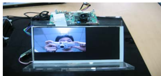
그림 5 일부 보완된 ARM9를 이용한 영상단말기 Fig. 5 The image terminal using complemented ARM9
