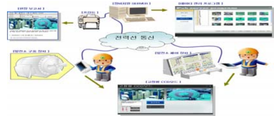
그림 4 고정형 CCD 모드를 이용한 시스템 구성 Fig. 4 The system composition using the fixed type CCD mode
