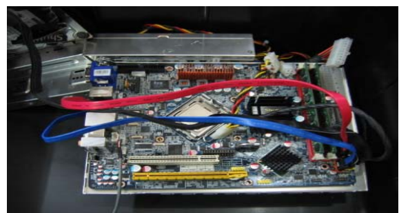
그림 20 영상 서버의 내부 모습 Fig. 20 The inner construct diagram of image server
