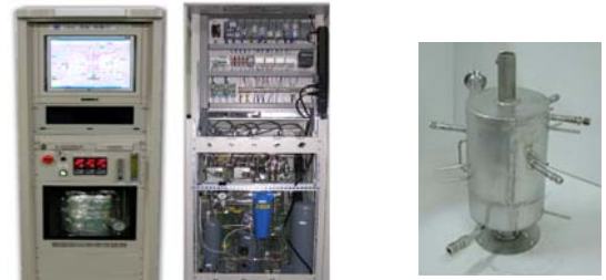
그림 4 수증기 메탄 개질기 Fig. 4 Steam methane reformer
