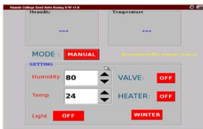
그림 5 MCRS 환경제어장치의 OS 제작도 Fig. 5 OS Simulation diag. of MCRS Environmental Control System
