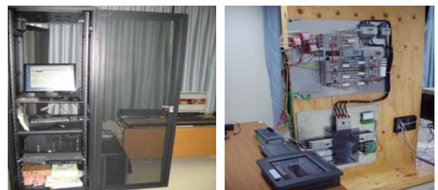
그림 7 서버 및 상가 분전반 설치 구성 Fig. 7 Sever and low voltage panelboard of store
