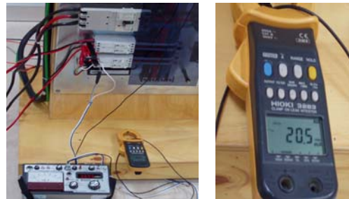
그림 11 누전 발생 실험 구성 Fig. 11 Test system of leakage current generation
