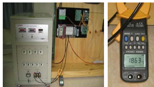
그림 13 과부하 발생 실험 구성 Fig. 13 Test system of over load generation
