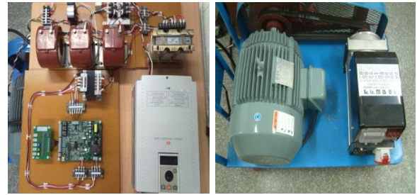
그림 8 실험장치 (좌 : 리액터, 전력용 변류기 그리고 DAVR / 우 : 유도전동기와 동기발전기)
