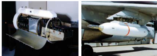
그림 8. AIM-9X CTP와 F/A-18 항공기 장착 형상
