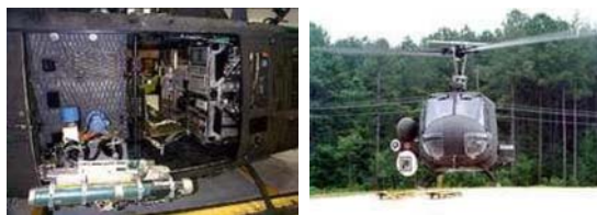
그림 5. UH-1 헬기의 탐색기 장착과 탑재비행시험
