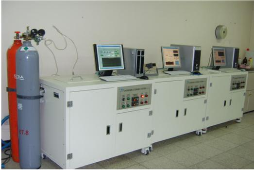
Fig 1. Sievert's type 수소저장장치
