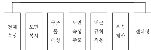
그림 3. 철근 배근도 설계 자동화 흐름
