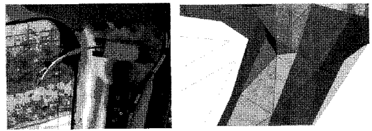
(a) 실제 차량 급전부 사진 (b) 시뮬레이션 적용 위한 급전부 형상
