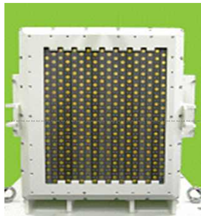
그림 5. 제작된 능동 위상 배열 안테나 Fig. 5. Developed active phased array antenna(APAA).
