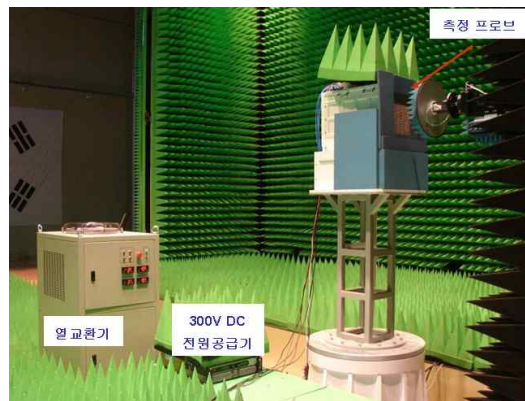
그림 16. 안테나 패턴 측정 구성도
