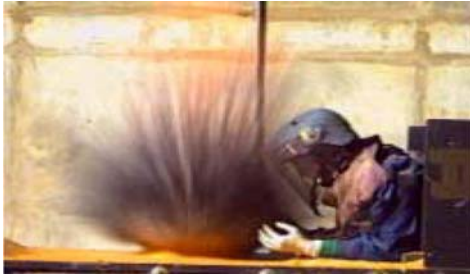
Fig. 4 폭발물의 비산파편 모의실험.
