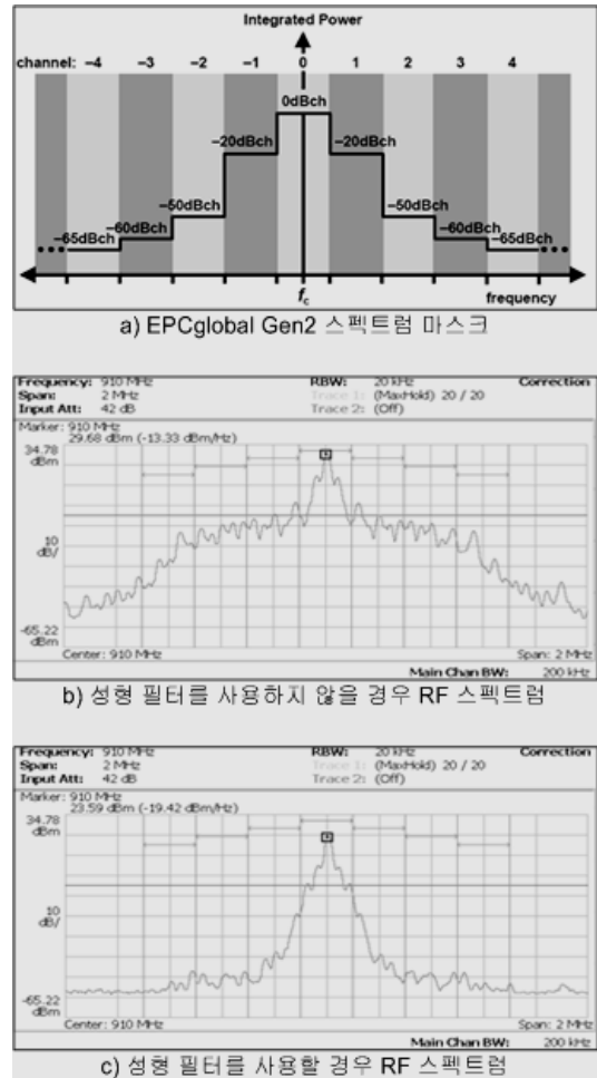
그림 4. ISO/IEC18000-6REV1 리더 시스템의 RF 출력
