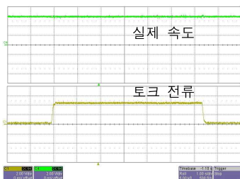
그림 12. 부하 변동에 따른 속도 제어 응답(900rpm) (0%→100%→0%) Fig 12. Speed regulation against load variation (0%→100%→0%)
