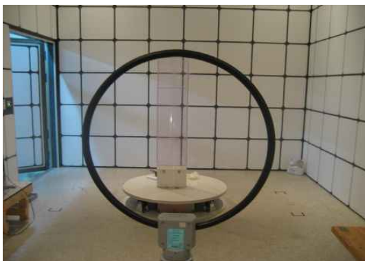
그림 3. EAS와 루프안테나의 수평 배치 Fig 3. Horizontality arrangement between EAS and loop antenna
