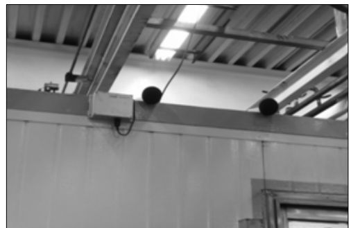
[사진 3] 차체 1반 뒤쪽에 배치되어 있는 휴게실 실 내, 외 소음 센서 측정 모습
