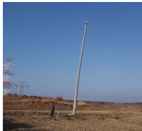
그림 2. 전주 인장실험(TEST-6) Fig. 2. Tensile test of electric pole
