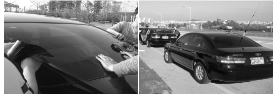
<그림 3> 선틱지부착 및 실험차량 <Fig. 3> Attachment of tinting films and experimental vehicle
