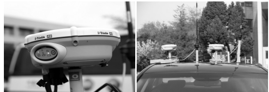
GPS수신기 (Trimble R8) 이동국(Rover) 안테나
