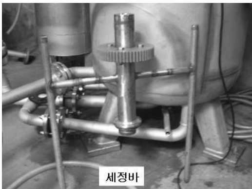
그림 3. 세정바의 모습 및 세정원리
