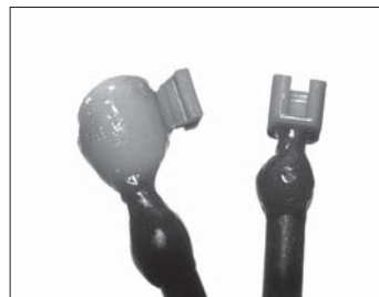
그림 7 납형에 male part 부착 후 동시에 female과 같이 주조
