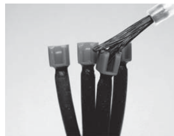
그림 3 주입선 부착 후 표면 장력제 도포
