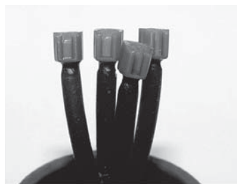
그림 3 주입선 부착 후 표면 장력제 도포
