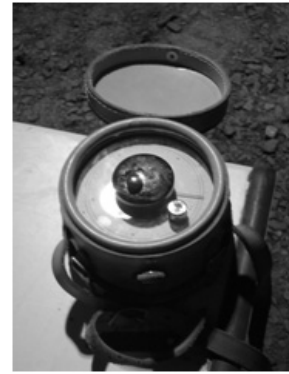
Fig. 10. 고도 측정 장비 Model T-5 altimeter
