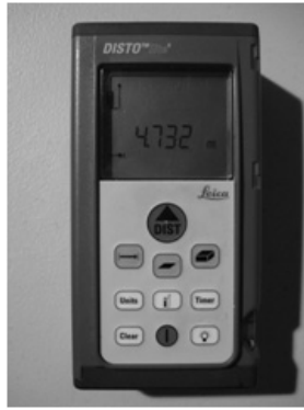
Fig. 9. 거리 측정 장비 DISTO™ lite
