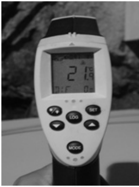
Fig. 8. 암반표면온도 측정 장비 ST20-Pro
