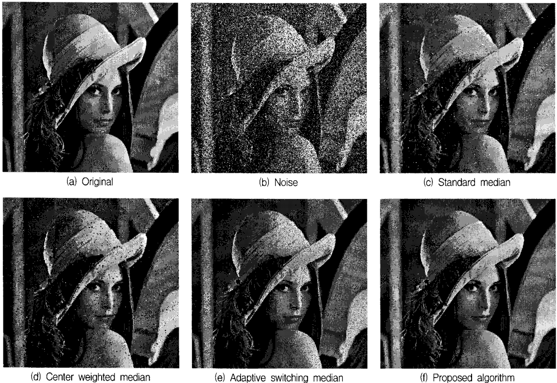
그림 3. 테스트 영상 (임펄스 노이즈 30%, 마스크 크기 3×3) Fig. 3. Test image. (Impulse noise 30%, Mask size 3×3)
