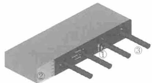
그림 2. Perfobond rib 전단연결재의 전단저항
