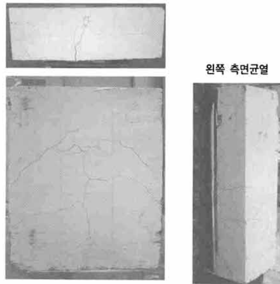
그림 8. Push-out 시험체의 파괴형상(PF-C30)
