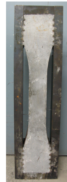
Photo 3 건조수축 균열 실험
