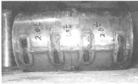
(b) 일체형 강판의 실험 후 모습 그림 6. 강판보강의 파괴양상
