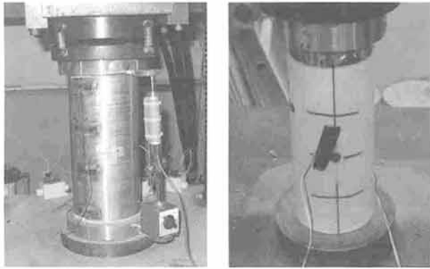
(a) 강판 보강 (b) GFRP 보강
