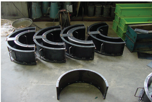
Photo 1 라이닝 콘크리트 시험체의 강제 거푸집
