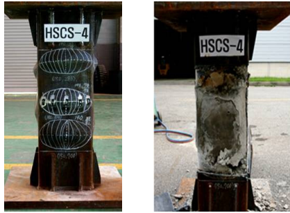
b. 강관의 좌굴파괴형상 c. 내부콘크리트의 파괴형상 그림 4. 실험체 세팅전경 및 가력후 실험체 모드
